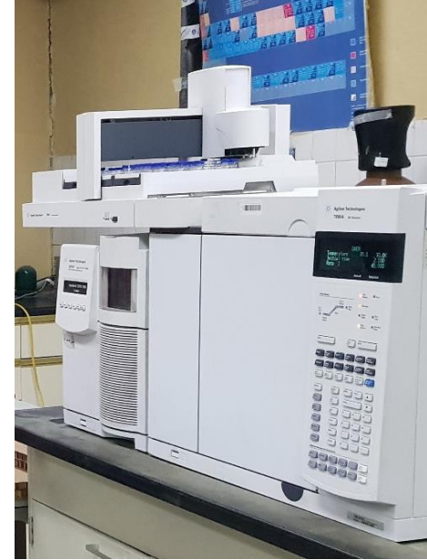
Cromatógrafo de Gases Agilent 7890A acoplado a un detector de Masas 5975C de Agilent Technologies,
